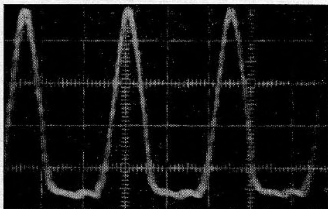
Фиг. 4. Осциллограмма силы ударного взаимодействия инструмента с изделием
