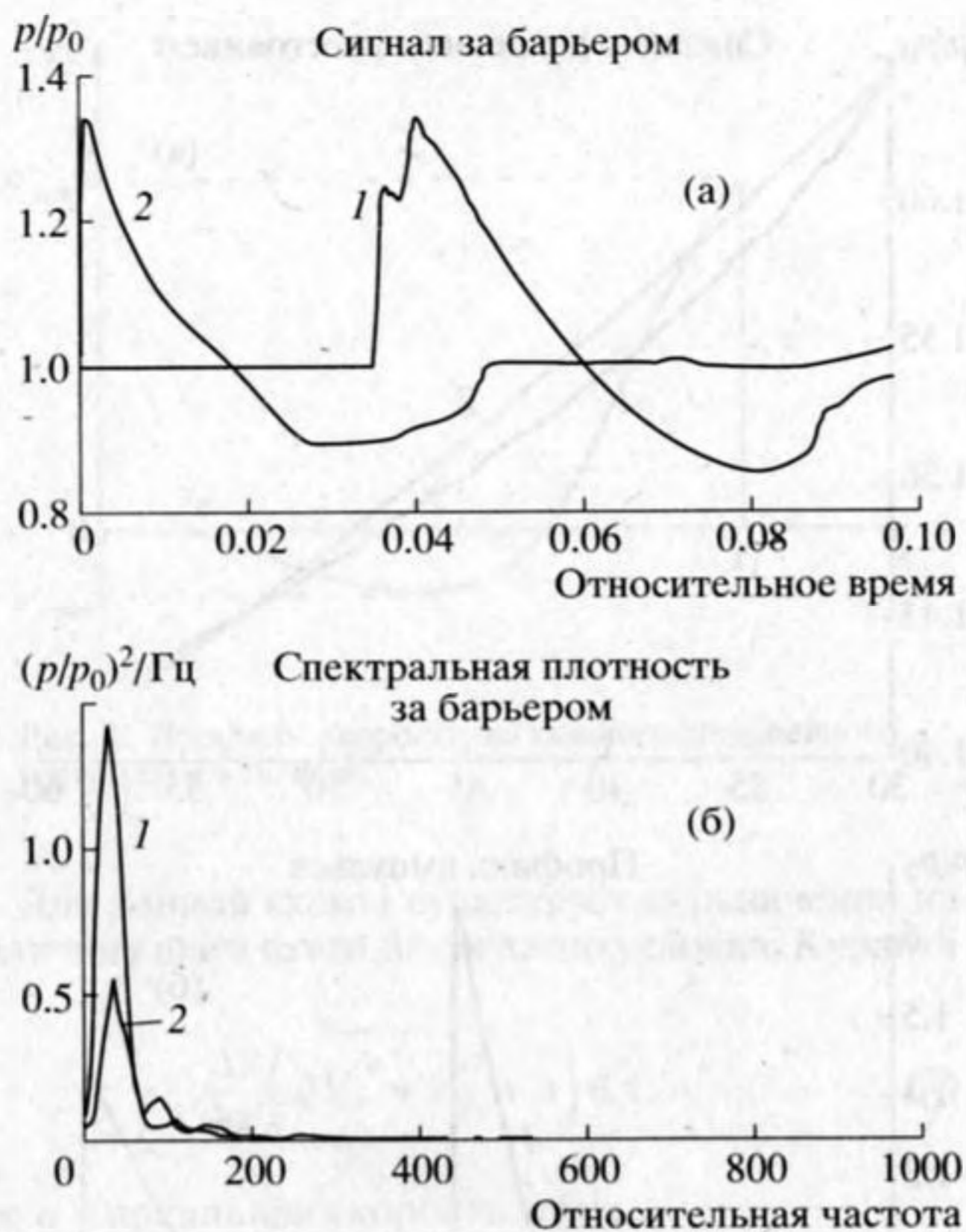
Рис. 4. Сравнение численных расчетов дифракции акустического импульса на прямоугольном выступе с расчетами по теории Маякавы [1]: 1 – конечно-разностное решение; 2 – расчет по теории Маякавы.
