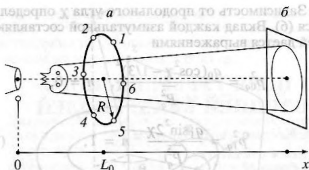
Рис. 2. Схема эксперимента. а — решетка микрофонов, б — экран с шелковинками.
