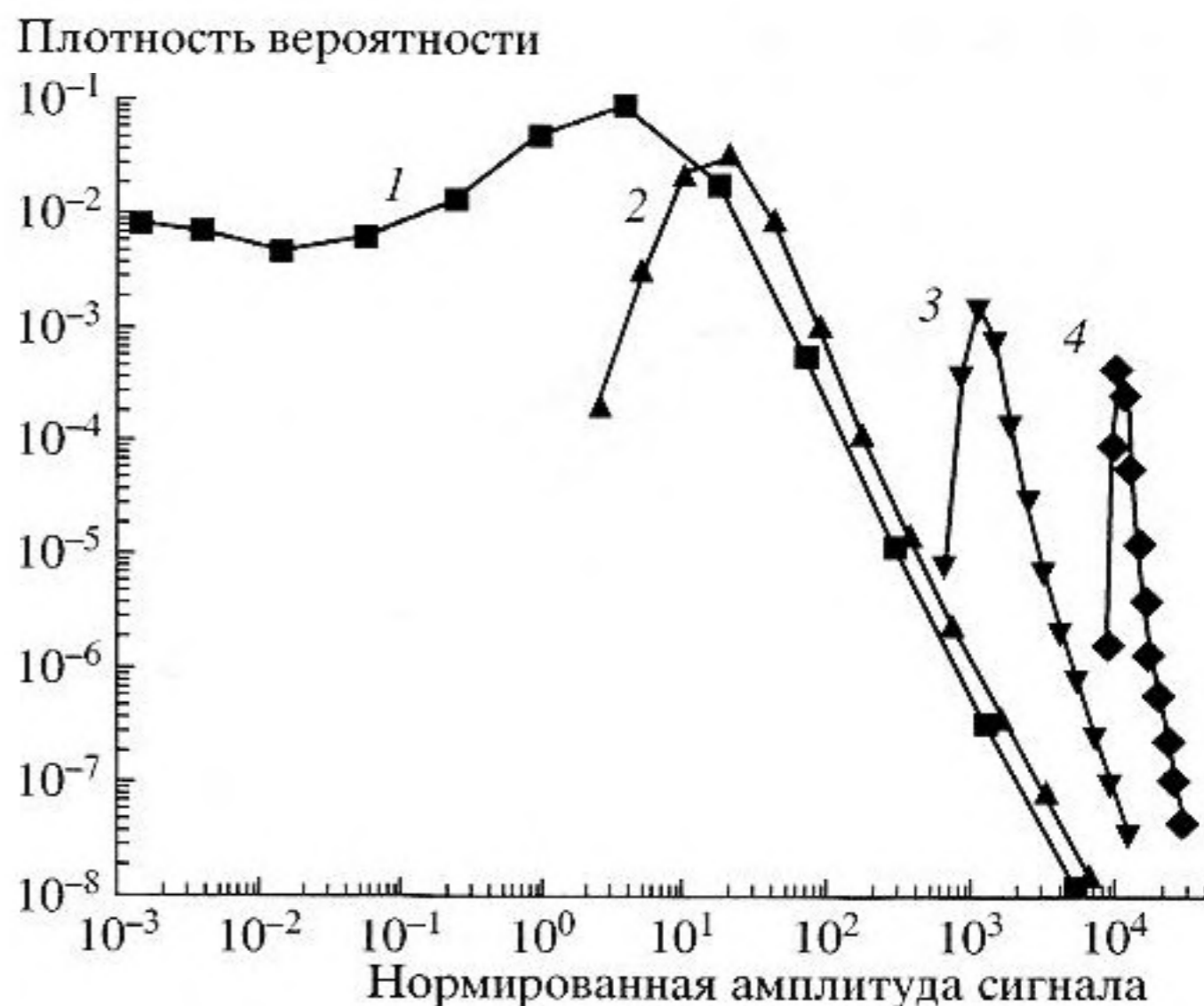
Рис. 5. Кавитационная составляющая сигнала. Плотность распределения вероятности нормированной амплитуды сигнала в двойных логарифмических координатах для серий, полученных при значении энергетического параметра \gamma = 10^4 и следующего числа частиц в суспензии N_p = 10 (кривая 1); 30 (2); 1000 (3); 10^4 (4). Результаты численного моделирования. Среднее число частиц над порогом, соответственно, составляет: 5.7; 17; 570; 5700.
