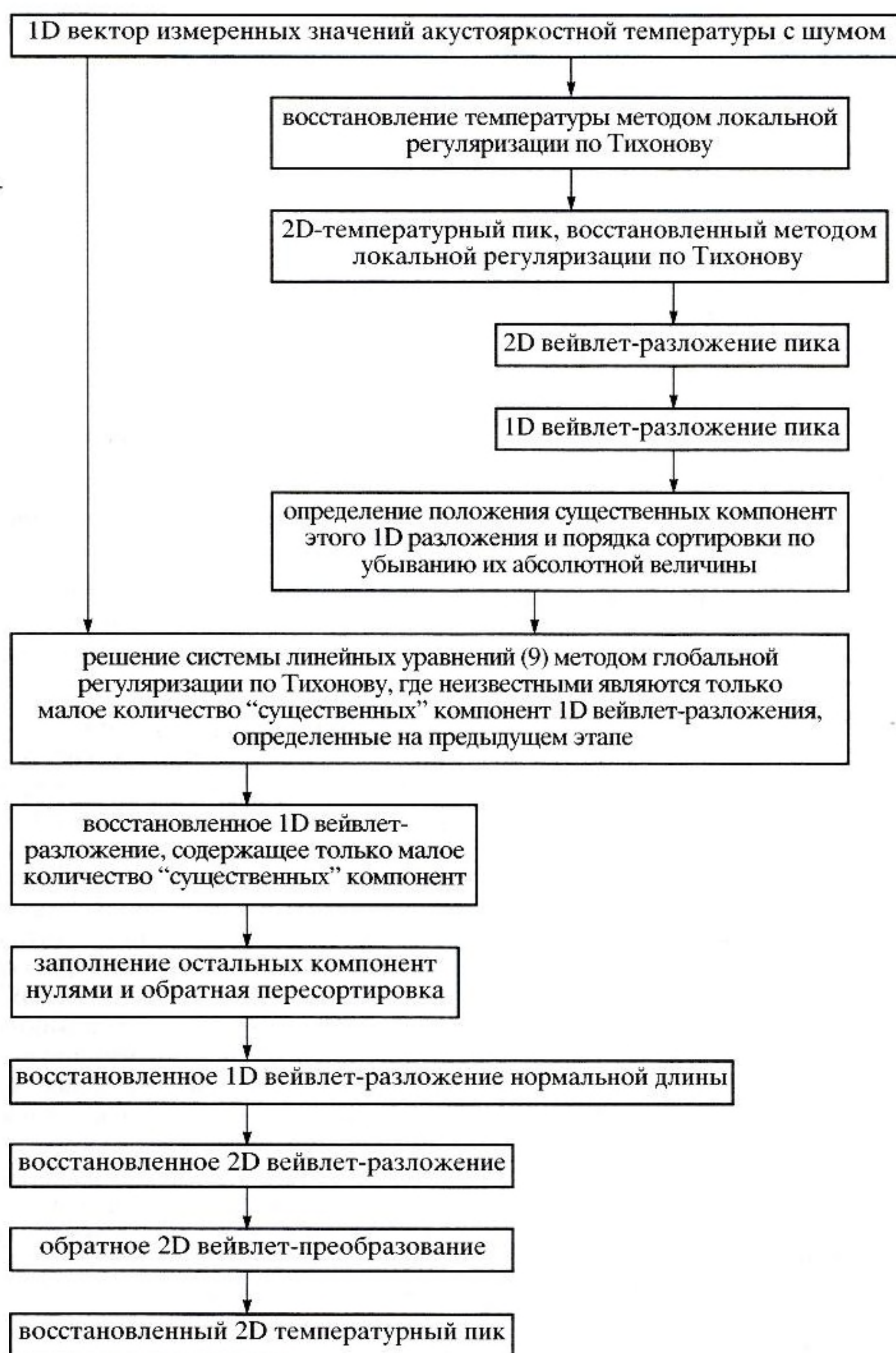
Рис. 3. Схема решения обратной задачи акустотермографии с применением вейвлет-преобразования.
