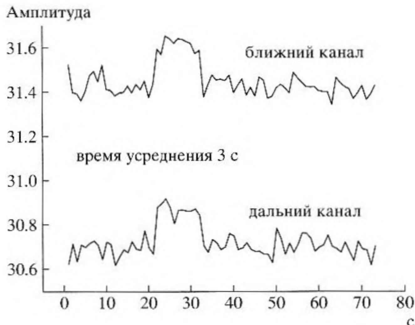
Рис. 3. Зависимость от времени среднеквадратичного значения амплитуд сигналов по обоим каналам при времени усреднения 3 с.
