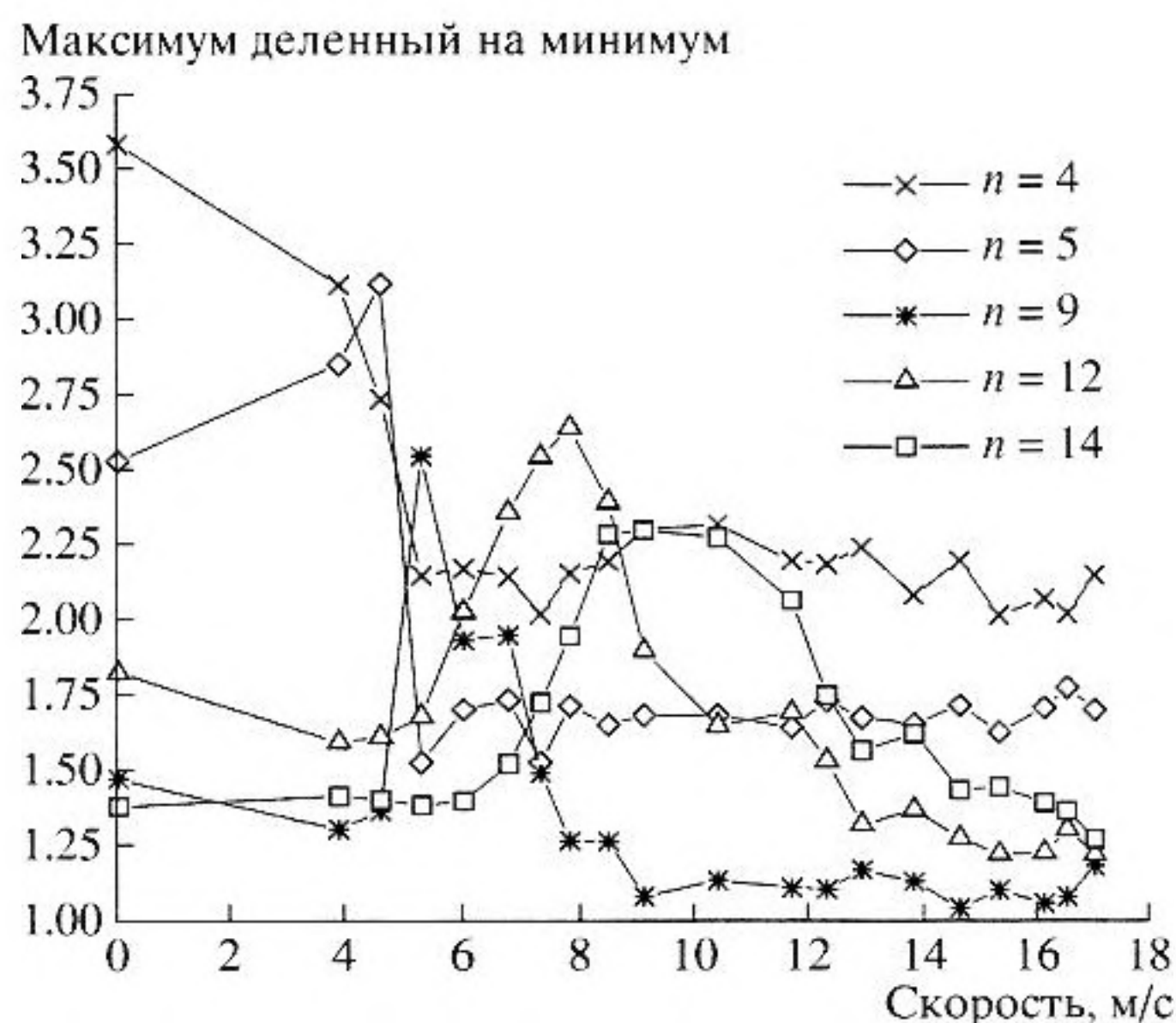
Рис. 5. Зависимость отношения резонансного максимума к соответствующему минимуму от скорости для разных собственных частот трубки.
