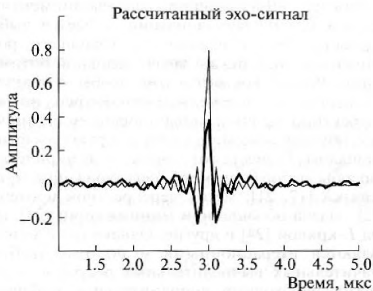
Рис. 3. Вид эхо-сигнала с постоянным спектром от 0.01 до 9.9 МГц (тонкая линия) и вид эхо сигнала с постоянным спектром от 1.5 до 5.5 МГц (толстая линия).
