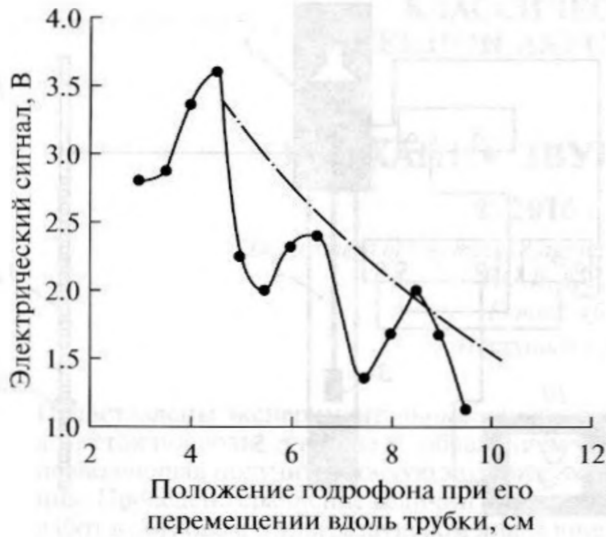
Рис. 2. Распределение максимумов и минимумов звукового давления в пене вдоль стаканчика.
