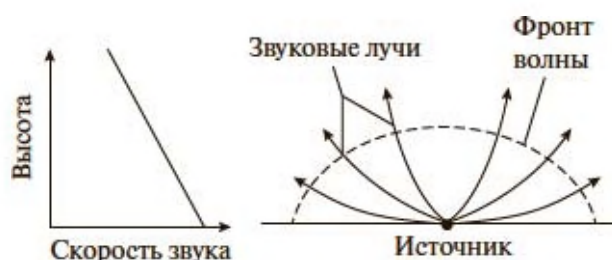
Рис. 6. Лучевая картина распространения акустического импульса при неустойчивой стратификации погранслоя [16].
